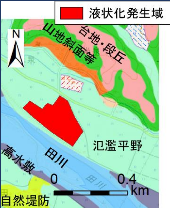
土地条件図に液状化発生域を重ね合わせ
