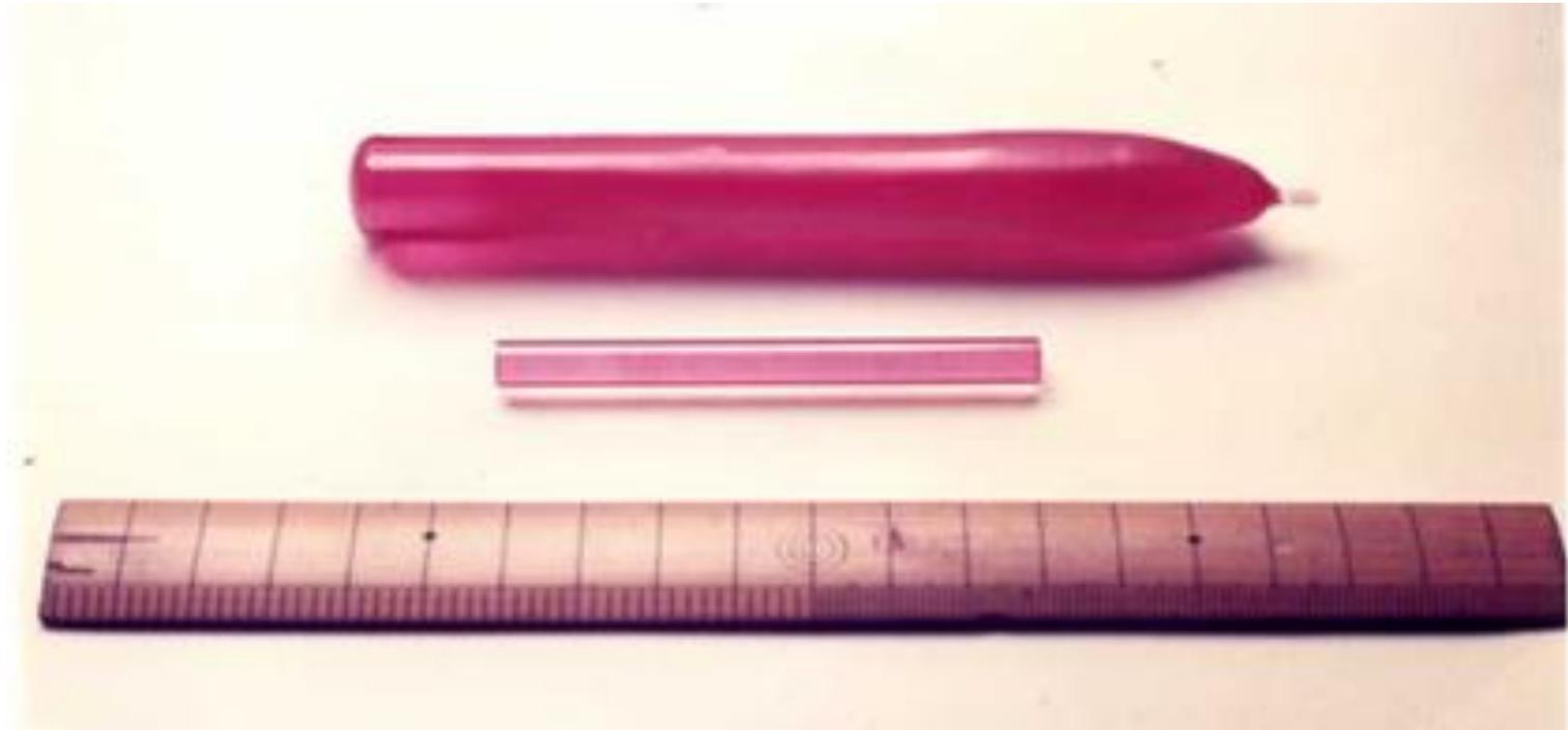
Ruby原石とレーザー発振用ロッド(8φ×75L in mm)
